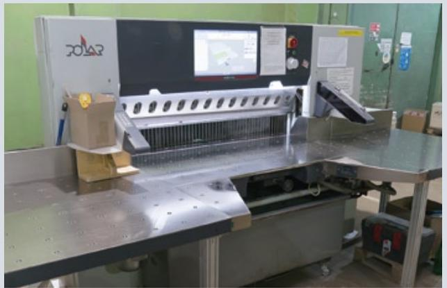
Новая высокоавтоматизированная резальная машина Polar N 137 Plus с системой Autotrim, которая позволяет избавиться от ручной работы по удалению обрезков. Аналогичная машина в типографии работает уже несколько лет (фото справа)
