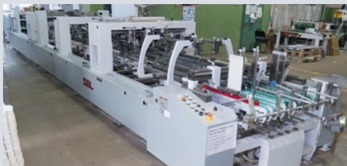
Фальцесклейка SBL 1100 успешно используется для склеивания коробок различных конструкций
