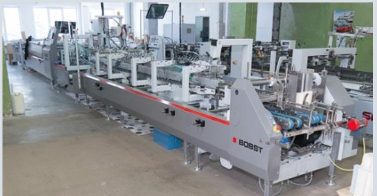
Оборудование Bobst для изготовления складных картонных коробок: Пресс для высечки Novacut 106 E и фальцевально-склеивающая линия VisionFold 80A2 хорошо себя зарекомендовали
