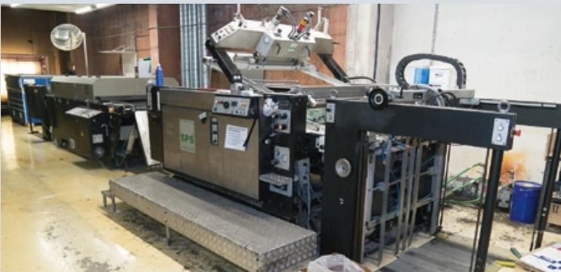
Автоматическая линия нанесения трафаретных лаков и покрытий SPS REHMUS Vitessa XP с гибридной сушкой
