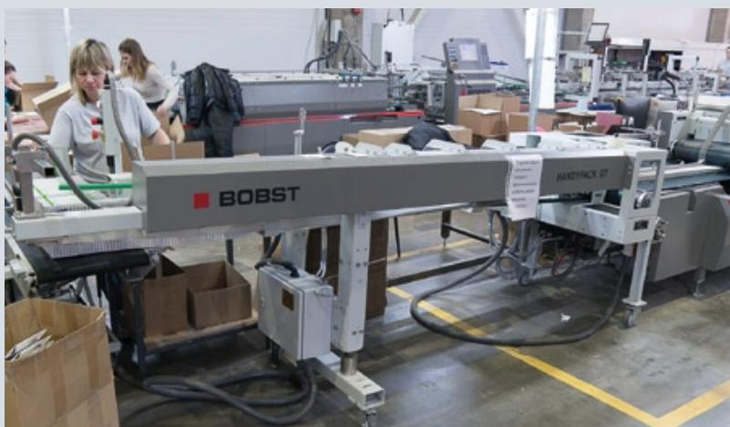
Одну из фальцевально-склеивающих линий Bobst оснастили модулем Handpack GT. Система позиционирует коробки на транспортировочной ленте для более удобного их съема оператором
