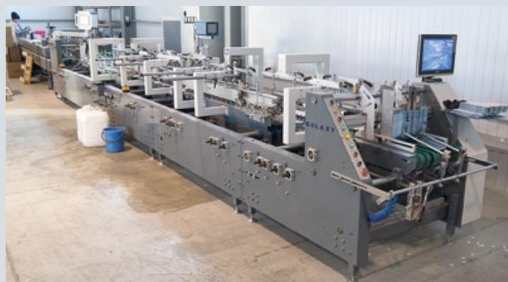
*Часть комплекса послепечатного оборудования для производства упаковочной продукции: вырубной пресс, резательный комплекс, фальцевально-склеивающая линия*
