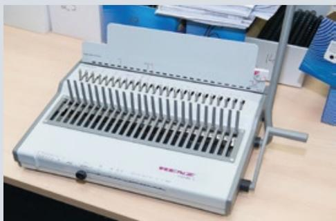
Инженерная документация сшивается в папки формата А4 на пластиковую пружину на таких брошюровщиках
