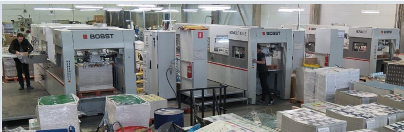
Так сейчас выглядит цех вырубки в типографии «Люксукак». За последние полтора года на производственной площадке установлены три вырубных прессы Bobst Novacut 106 E, что позволило типографии увеличить производительность участка на 30%
