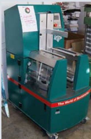
Вкладочно-швейно-резальная линия для изготовления продукции со скреплением на скобу
