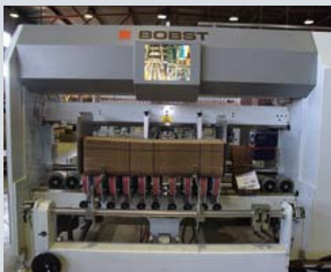
Подача вырубленных заготовок гофроупаковки на фальцевально-склеивающую машину
