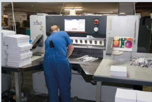
Часть комплекса послепечатного оборудования от Heidelberg — резальная машина Polar 115 и фальцевальная машина Stahlfolder 66
