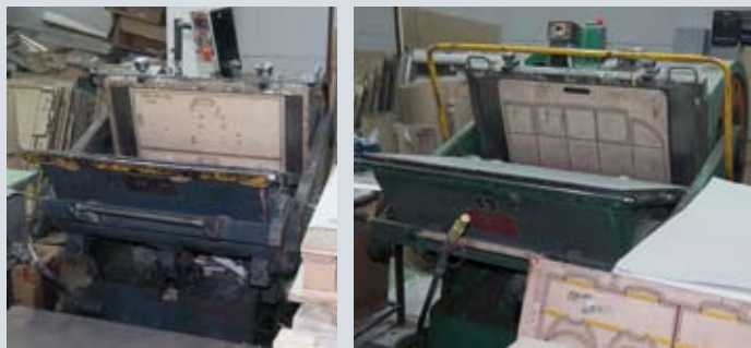
На производстве используются более 10 тигельных прессов для вырубки картона, что удобно при изготовлении небольших тиражей картонных коробок
