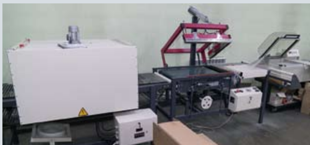
Часть послепечатного оборудования типографии «Виннер» — резальный комплекс и автоматизированная линия для упаковки готовой продукции
