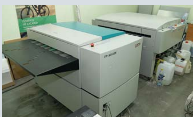
В типографии оборудован собственный участок вывода печатных форм на базе оборудования Cron
