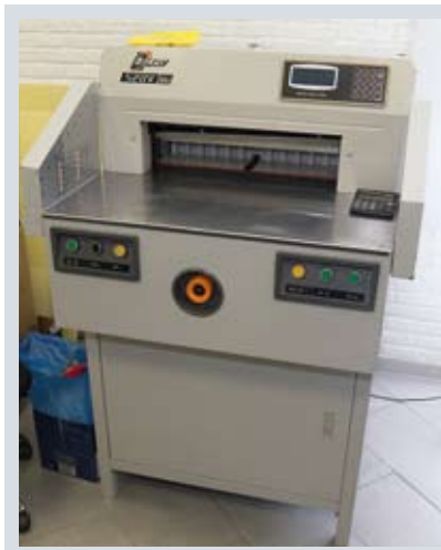
Необходимый набор послепечатного оборудования копирующего салона: резальное устройство для подрезки отпечатанных изделий, а также комплекс для переплетных работ (изготовления изделий со скреплением на пластиковую или металлическую пружину)
