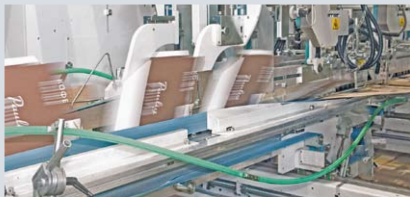
Фальцевально-склеивающая линия BOBST Expertfold 230 с возможностью склейки до 6 точек. Линия оснащена системой видеоконтроля, гарантирующей высокое качество склейки
