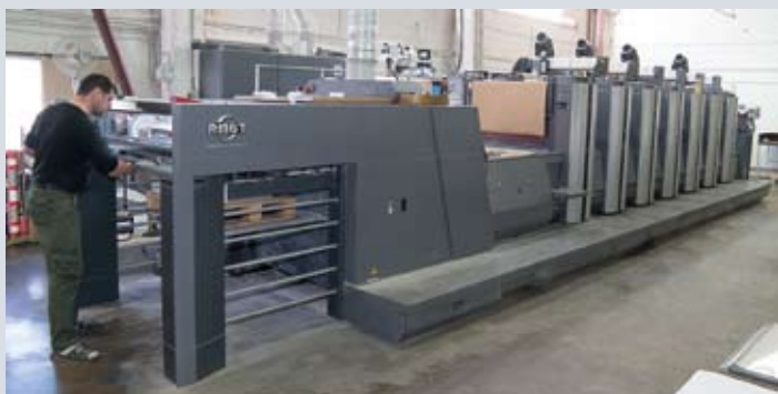
Для изготовления продукции с УФ-печатью используется также шестикрасочная печатная машина RMGT 926 LED-UV
