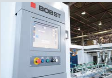
Фальцевально-склеивающая линия BOBST Expertfold 230 с возможностью склейки до 6 точек. Линия оснащена системой видеоконтроля, гарантирующей высокое качество склейки
