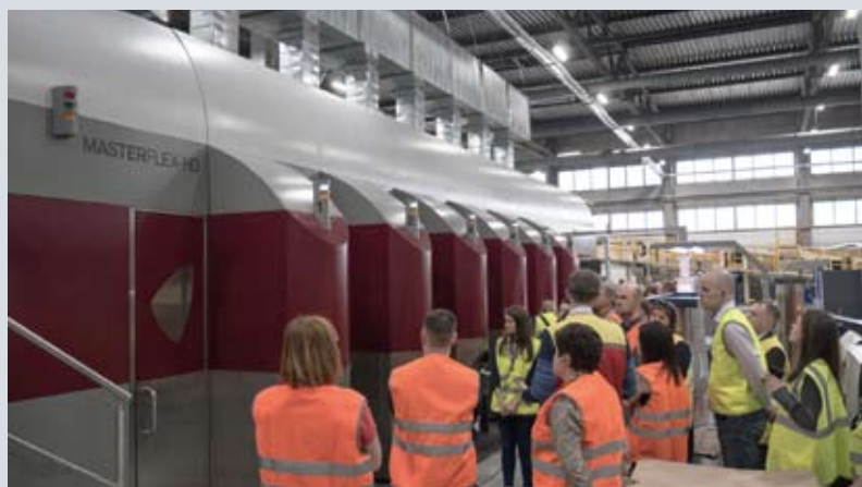
Вторая линия флексографской печати Masterflex-HD6 в шестикрасочном исполнении от компании BOBST инсталлирована на предприятии в 2019 г. Она позволяет выпускать продукцию с фотографическим качеством, использовать дополнительные краски (Pantone, металлизированные, флуоресцентные), а также воспроизводить текст с мелким шрифтом, что обеспечивает компании возможность выпускать гофроупаковку с защитой от копирования. В прошлом году в линию к печатной машине был установлен вырубной пресс BOBST Mastercut 2.1, что позволило получать готовую продукцию за один цикл
