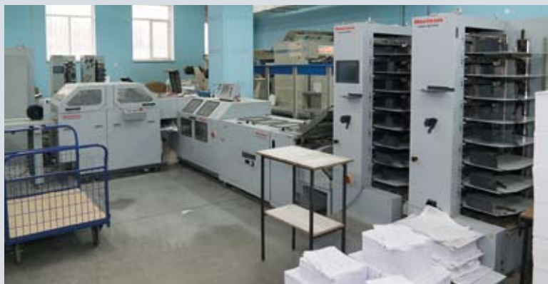
Оборудование компании Horizon разных годов выпуска: листоподборочные машины, вкладочно-швейно-резальные линии для изготовления многополосной печатной продукции (книг и журналов). Справа внизу — брошюровочный комплекс Horizon Stitchliner 6000, оснащенный высокопроизводительными финишными модулями для биговки, фальцовки, шитья проволокой, прессования и трехсторонней подрезки брошюр
