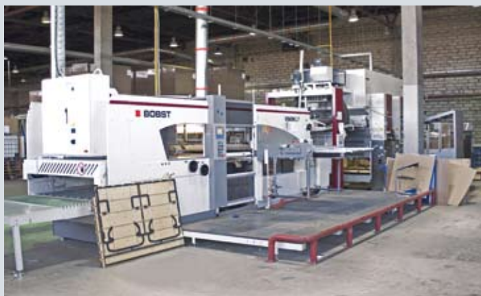
Вырубной пресс BOBST Visioncut 1.6 монтируется в линию с флексографской печатной машиной, что позволяет за один производственный цикл получить готовое изделие
