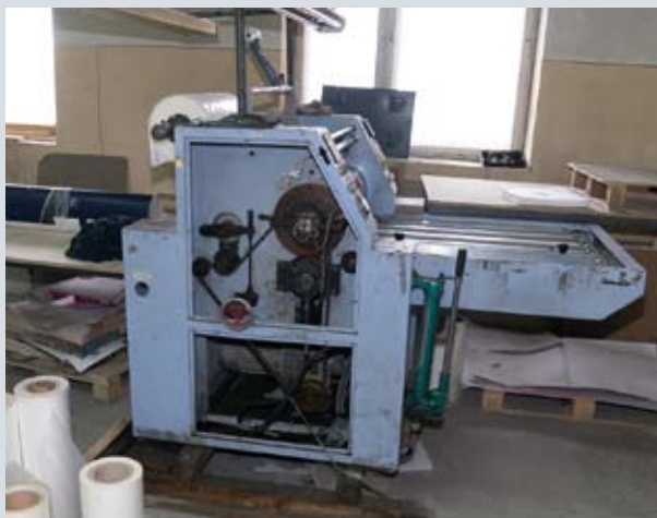
Оборудование для ламинирования запечатанных листов с макетами будущих коробок
