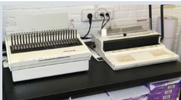
Необходимый набор послепечатного оборудования копирующего салона: резальное устройство для подрезки отпечатанных изделий, а также комплекс для переплетных работ (изготовления изделий со скреплением на пластиковую или металлическую пружину)
