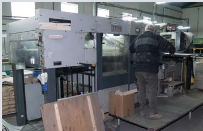
Автоматизированное высекальное оборудование первого формата от компании BOBST используется для работы с плотным картоном
