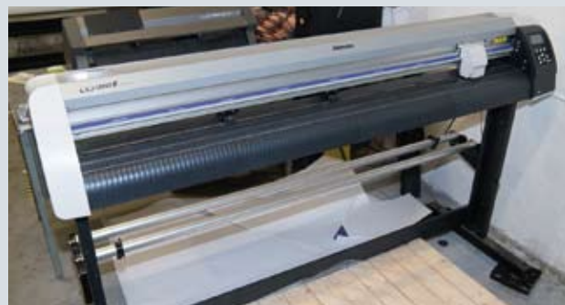
Цех широкоформатной печати представлен печатающим устройством с шириной до 1,6 м, а также двумя режущими плоттерами. Оборудование предназначено для изготовления баннеров, плакатов, постеров и др.
