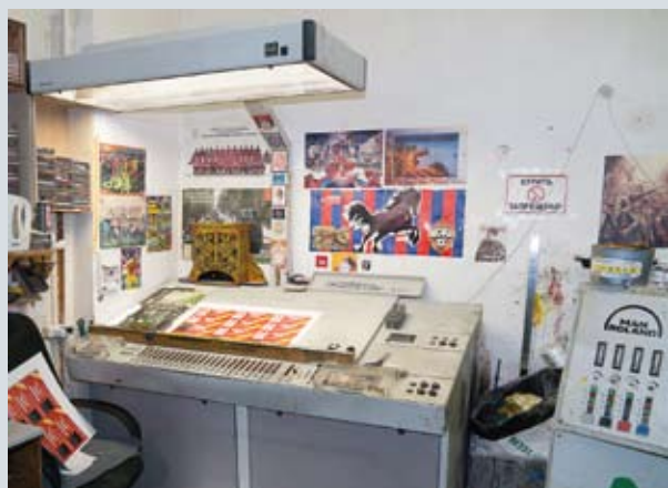
Печатная машина второго формата Roland 200 составляет основу офсетного парка типографии «РПК24»
