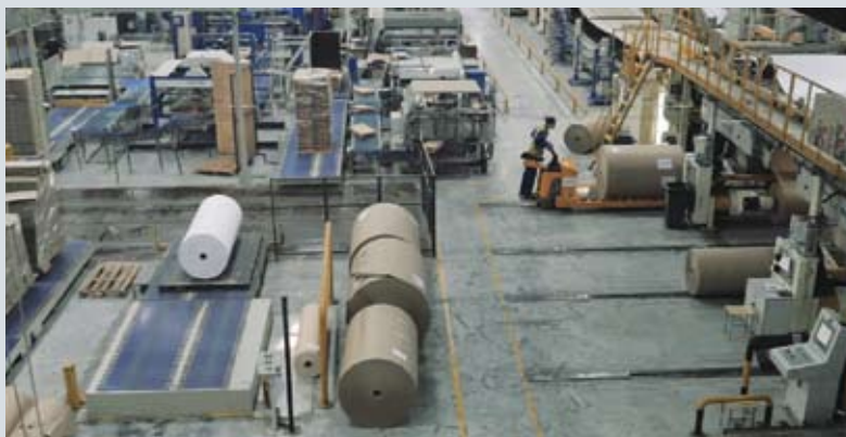
На фото видно, как рулоны с материалом, изготовленные на собственной бумагоделательной фабрике «Рэмос-Альфа», загружаются в гофроагрегат, где задаются параметры изготовления гофрокартона с необходимым профилем и плотностью верхнего слоя
