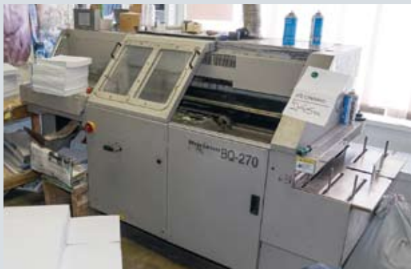
Оборудование Horizon BQ-270 для клеевого бесшвейного скрепления многостраничных блоков
