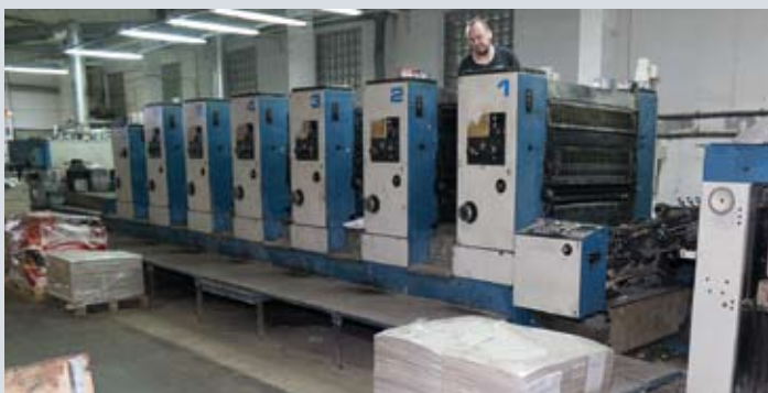
В оснащении типографии «Магнус» многокрасочные офсетные печатные машины первого формата, предназначенные для печати на плотных материалах и лайнерах для последующего каширования
