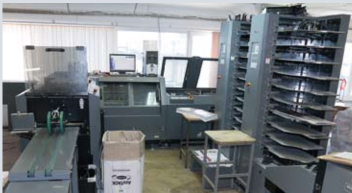
Вкладочно-швейно-резальная линия для изготовления продукции со скреплением на скобу
