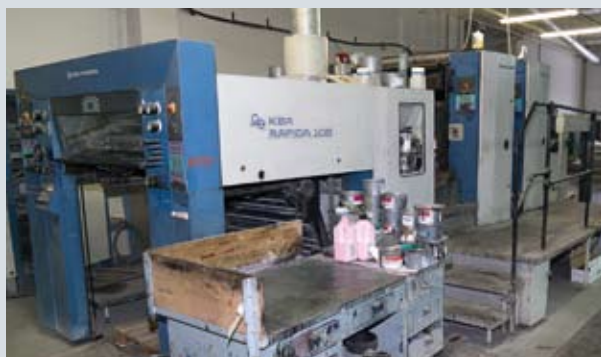
В оснащении типографии «Магнус» многокрасочные офсетные печатные машины первого формата, предназначенные для печати на плотных материалах и лайнерах для последующего каширования
