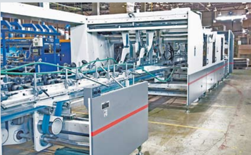
Подача вырубленных заготовок гофроупаковки на фальцевально-склеивающую машину
