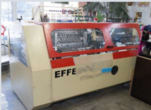
Комплекс для производства книг в твердом переплете с шитым нитками блоком
