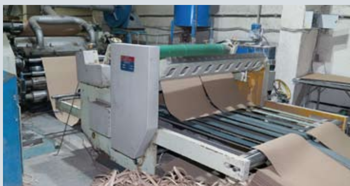
На предприятии установлены две линии по производству микрогофрокартона разных профилей, что позволяет обеспечивать потребности компании в сырье и снижает себестоимость производства
