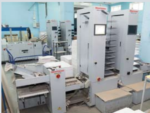
Оборудование компании Horizon разных годов выпуска: листоподборочные машины, вкладочно-швейно-резальные линии для изготовления многополосной печатной продукции (книг и журналов). Справа внизу — брошюровочный комплекс Horizon Stitchliner 6000, оснащенный высокопроизводительными финишными модулями для биговки, фальцовки, шитья проволокой, прессования и трехсторонней подрезки брошюр
