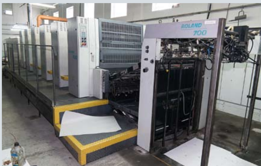
В конце 2020 г. типография «Магнус» приобрела пятикрасочную печатную машину Roland 700 с секцией лакирования. Благодаря ей на предприятии планируют развивать новые направления упаковочного бизнеса
