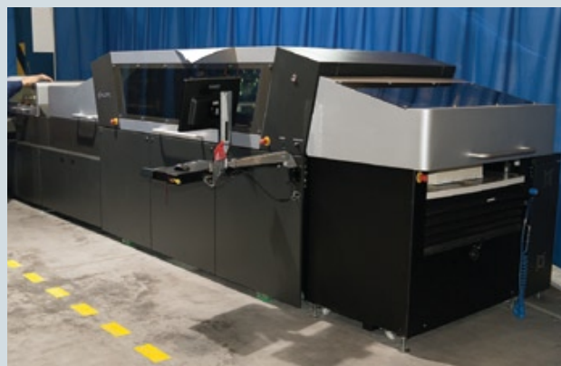
Устройство цифрового выборочного лакирования Scodix, благодаря которому можно получить еще более впечатляющие эффекты отделки оттисков
