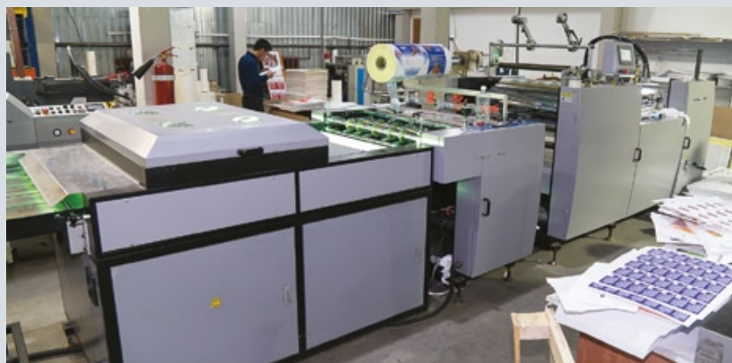
Промышленный ламинатор, оснащенный УФ-лампами, для получения более качественной припрессовки пленки. На нем апробируются пленки, которые завозит компания Lamstore из Китая, а также выполняются заказы на ламинацию
