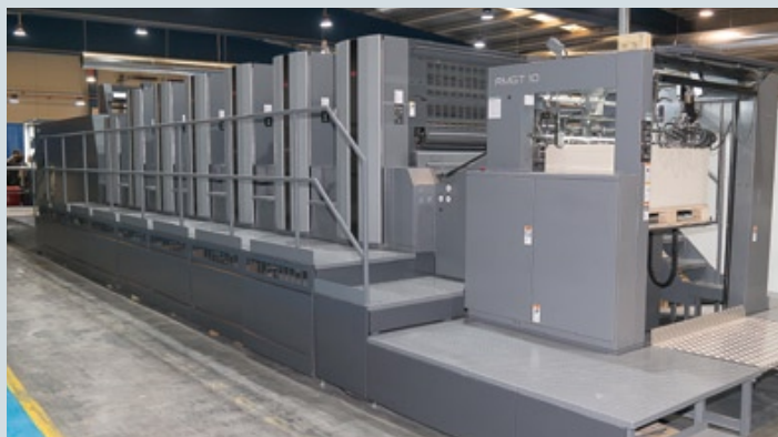
В типографии Litoturia установлены две печатные машины RMGT серии 10: одна из них шестикрасочная с секцией лакирования, вторая — восьмикрасочная с двумя секциями лакирования. Обе машины оснащены сушильными устройствами компании AMS Spectral UV
