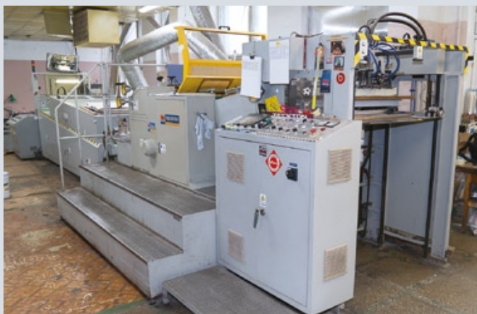
На фото трафаретная машина и лакировальная линия для выборочного и сплошного нанесения УФ и ВД-лаков
