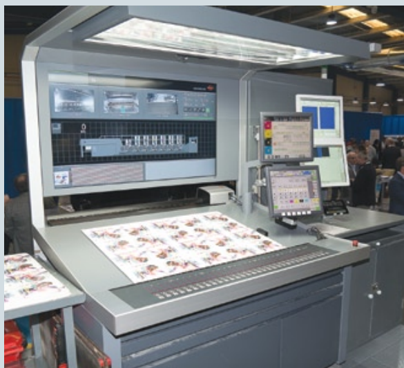
Развитый и наглядный пульт управления отражает все процессы, происходящие в машине
