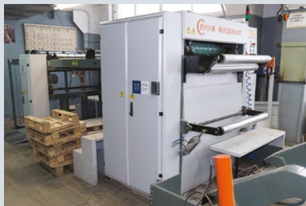
Сейчас в типографии появилась возможность работать с рулонным картоном, что позволяет разрезать материал на листы нужного формата под конкретный заказ
