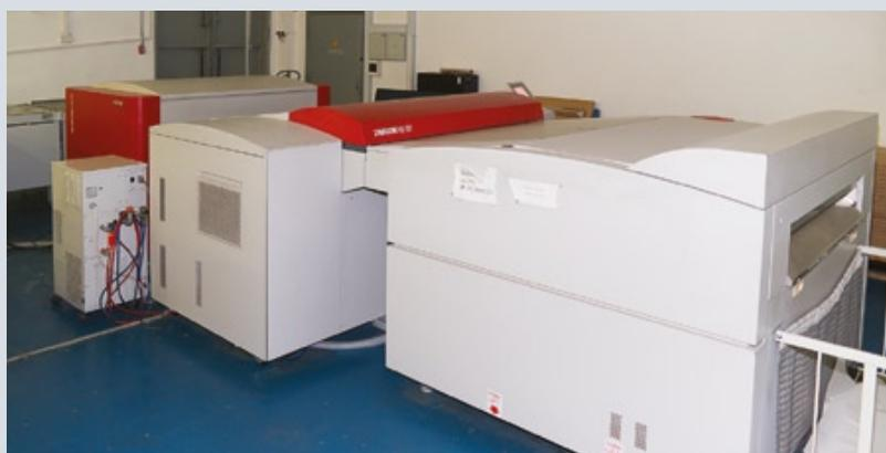
С момента появления «Московской Газетной Типографии» основные допечатные процессы ведутся на автоматизированной линии Agfa, состоящей из двух термальных CtP и устройства автоматической перфорации с оптическим определением положения изображения (фото слева). Используемые пластины также производства Agfa
