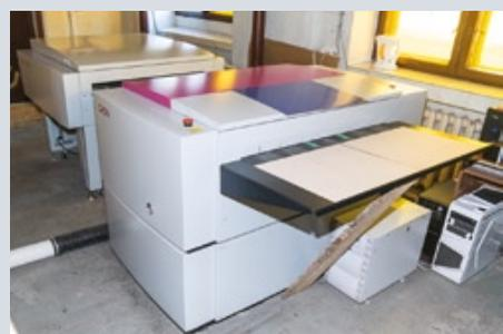
На предприятии работает устройство для вывода офсетных пластин
