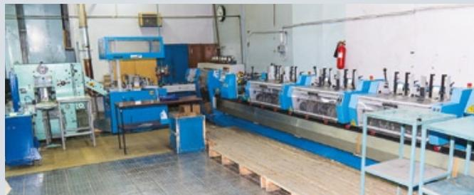
*В типографии МГТ работает мощный послепечатный комплекс оборудования: как экспедиционного (приемка и комплектовка тетрадей с печатной машины), так и оборудования для обработки тетрадей — ВШРА и линии КБС*
