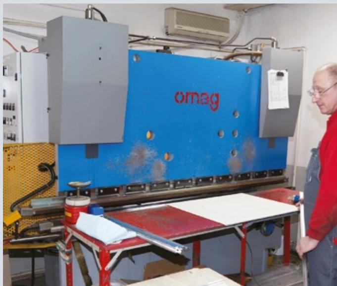
Цех по изготовлению резино-тканевых полотен: слева — автоматический раскрой и система карусельного хранения мастер-ролей полотен, справа — гидравлический станок для опрессовки металлических планок на резино-тканевой заготовке
