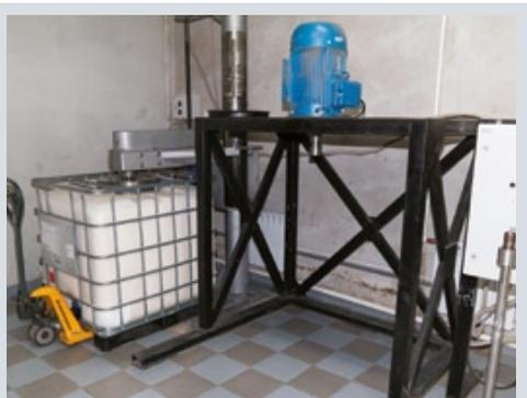
На производственном участке в Поварово работают миксеры для изготовления разных расходных материалов: слева — для проявителя для офсетных пластин, справа — для силиконовой эмульсии или увлажнения
