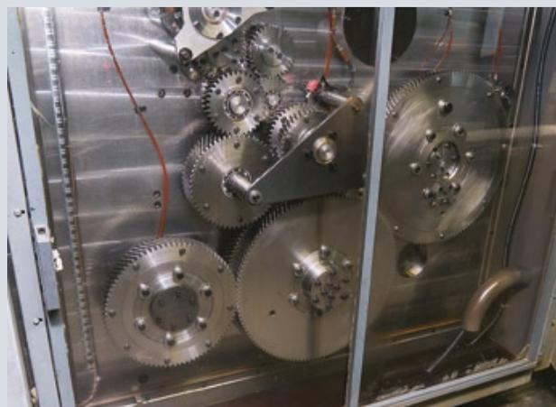
*Печать большинства продукции производится на машинах Goss: Universal 75 и Uniliner, причем механизмы закрыты прозрачными крышками, чтобы они были видны*
