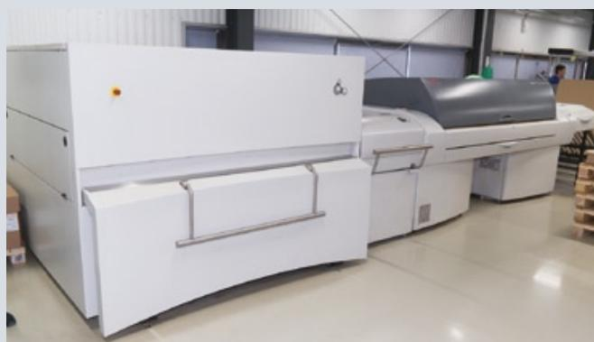
В «Парето-Принт» работают два выводных устройства Kodak Magnus VLF. Используемые ранее для проявки пластин процессоры демонтированы, теперь типография может работать только на беспроцессных пластинах Sonora XR
