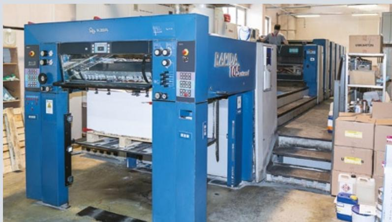
В настоящее время на производстве «Дитона» работают две печатные машины: полуформатный Heidelberg Spredmaster 74 и KBA Rapida 105 Universal листового формата
