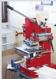
Для отделки печатной продукции используется линия трафаретной печати и простой пресс для тиснения фольгой
