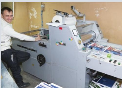
На производстве изготавливают и бумажные пакеты. Для этого оттиски ламинируют, затем вырезают на тигельной прессе и собирают вручную
