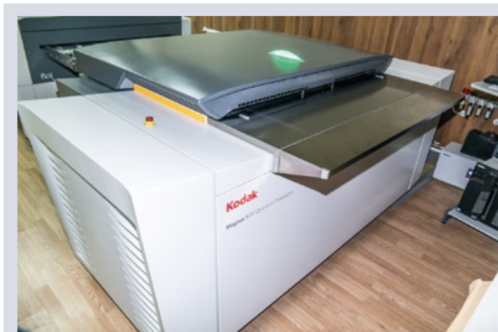
Для изготовления форм используется Kodak Magnus 800 Quantum
