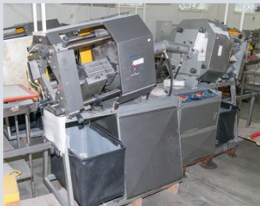
Стопцилиндровый пресс для тиснения фольгой (слева) и пресс для вырубки этикеток стопой. С этих машин начинался бизнес типографии. Сейчас в ней работает по несколько таких машин
