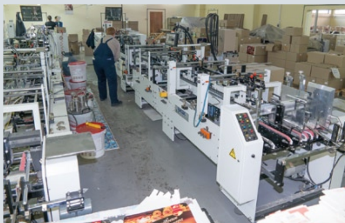
Послепечатное оборудование для изготовления упаковки (вырубные прессы и фальцесклейки) азиатского производства
