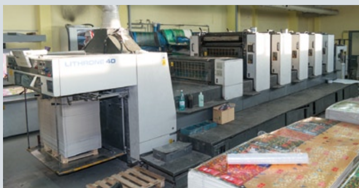
С этой машины — Komori Lithrone 40 — началось сотрудничество «ЯМ Интернешнл» и «Упаковки». На сегодняшний день она отпечатала уже более 300 млн отт.
