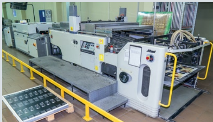
Для изготовления упаковки со сложной отделкой используется машина трафаретной печати
