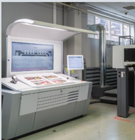
За печатные процессы в «Ситипринт» отвечает новейший восьмикрасочный перфектор Heidelberg Speedmaster XL 106, подготовленный для печати высокорективными красками
