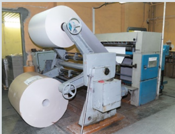
Флаторезки позволяют экономить картон, нарезая для каждого заказа строго необходимый размер
