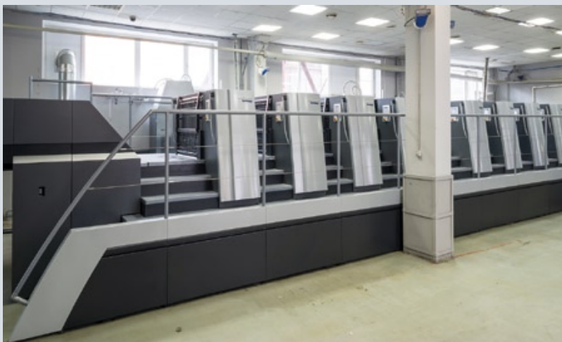
За печатные процессы в «Ситипринт» отвечает новейший восьмикрасочный перфектор Heidelberg Speedmaster XL 106, подготовленный для печати высокорективными красками
