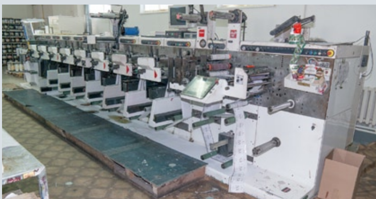
В типографии работает цех по изготовлению самоклеящейся этикетки флексографским способом, здесь есть многокрасочная печатная машина и комплексы для послепечатной обработки, в частности, для тиснения фольгой и конгревного тиснения
