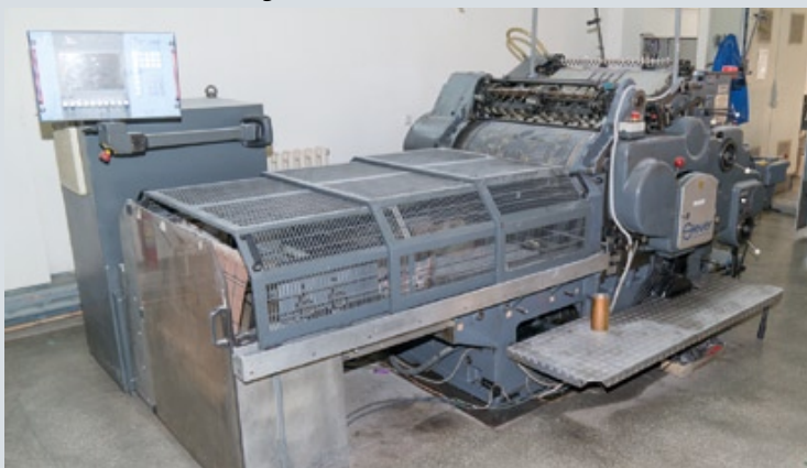
Стопцилиндровый пресс для тиснения фольгой (слева) и пресс для вырубки этикеток стопой. С этих машин начинался бизнес типографии. Сейчас в ней работает по несколько таких машин
