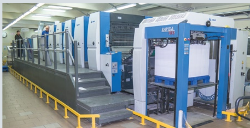
Парк печатных машин типографии «Авант» составляют две машины KBA Rapida 105, обе в шестикрасочном исполнении
