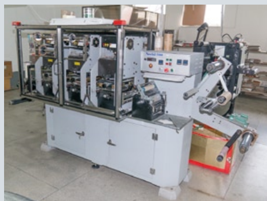
В типографии работает цех по изготовлению самоклеящейся этикетки флексографским способом, здесь есть многокрасочная печатная машина и комплексы для послепечатной обработки, в частности, для тиснения фольгой и конгревного тиснения
