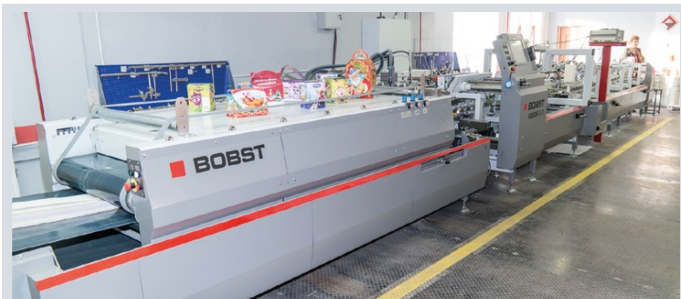
Новинка «Люксупак» — фальцевально-склеивающая линия Bobst Visionfold 110A2
