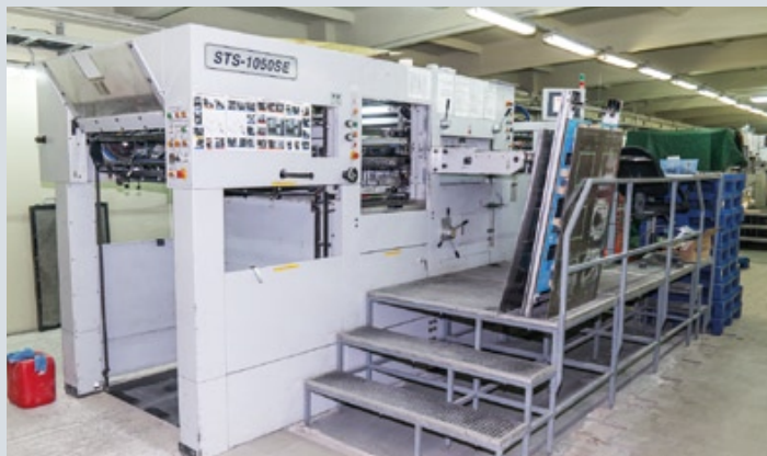
Послепечатное оборудование для изготовления упаковки (вырубные прессы и фальцесклейки) тайваньского производства
