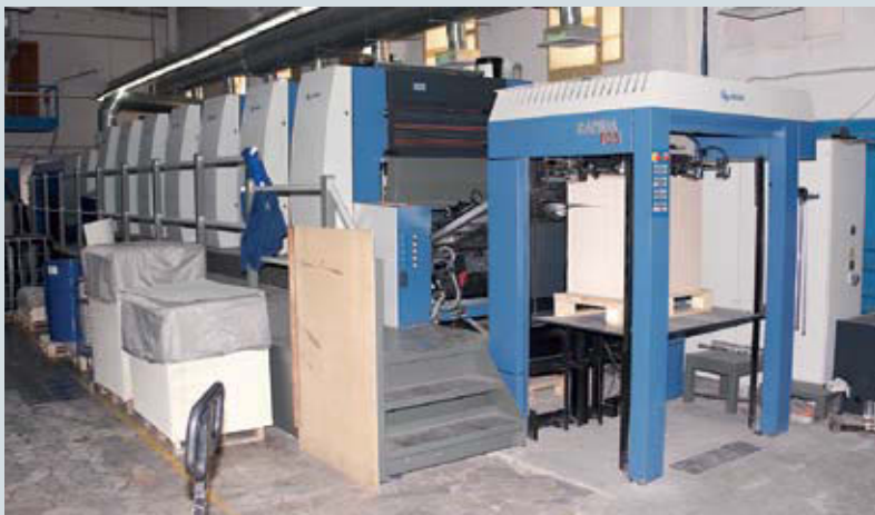
Семикрасочная машина KBA Rapida 105 с секцией лакирования, оснащенная для УФ-печати, была недавно установлена на «Молоковской картонажно-полиграфической фабрике». Это позволило предприятию предложить заказчикам услуги по производству упаковки на металлизированном картоне, а также повысить визуальное качество печати на обычном картоне
