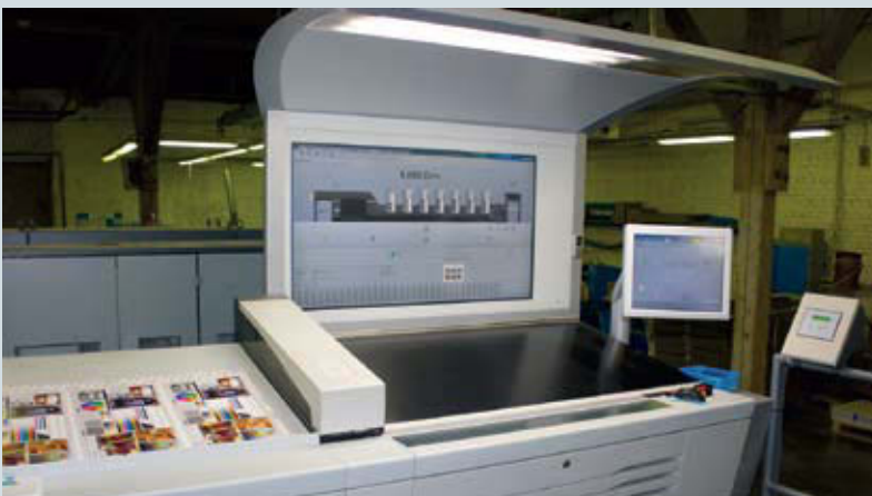
Heidelberg Speedmaster CX 102-6+L оснащена для работы не только традиционными масляными, но и традиционными и высокорезактивными УФ-красками. Уникальность машины еще и в установленных УФ-сушках, которые позволяют использовать как обычные УФ-лампы, так и энергосберегающие УФ-лампы нового поколения
