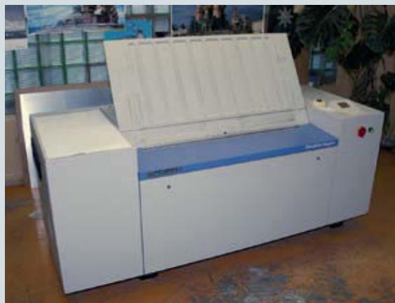
На МКПФ работает еще одна печатная машина от KBA — шестикрасочная Rapida 105U+L (слева). Офсетные печатные формы изготавливаются на CtP-устройстве Screen (справа)
