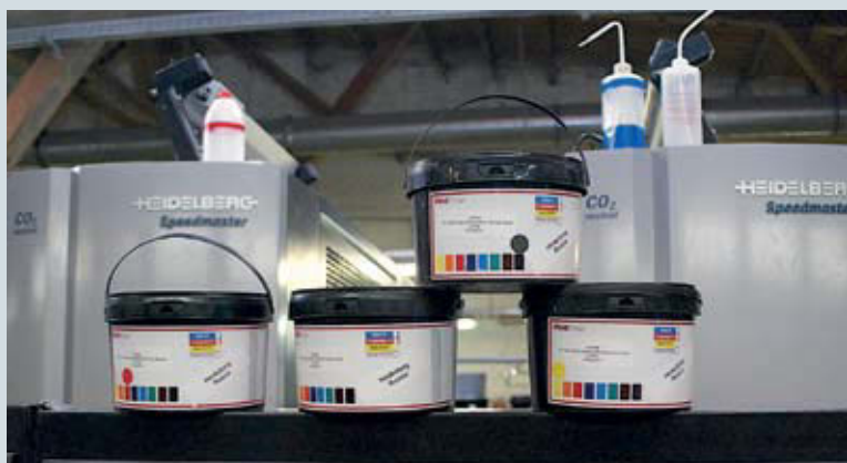
На презентации для печати на новой машине Heidelberg использовались специальные УФ-краски, предназначенные для закрепления под воздействием УФ-ламп со сниженным энергопотреблением. Эта технология еще недостаточно распространена даже в мировой полиграфической практике, но обещает немало перспектив для типографий. «Линия График» настроена разобраться в этой технологии на собственном опыте
