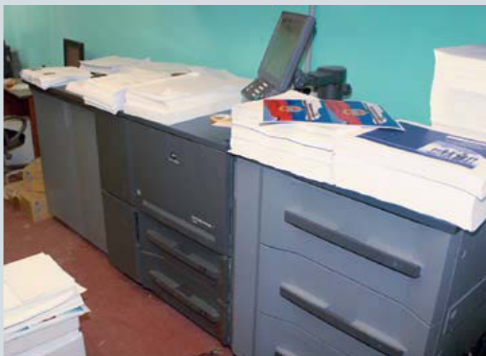
В типографии «ТИРАЖИ.RU» на сегодняшний день установлено четыре цифровых печатных машины Konica Minolta как для цветной, так и для монохромной печати. Слева — полноцветная профессиональная машина bizhub PRO C6000L, справа — bizhub PRESS 1250P для печати многополосных черно-белых изданий
