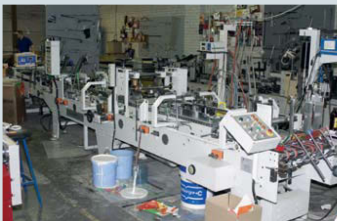
Для производства профильной для типографии продукции в «Линии График» используется послепечатное оборудование, рассчитанное на промышленные объемы. В частности, на фото: высокоскоростной вырубной пресс и фальцевально-склеивающая линия
