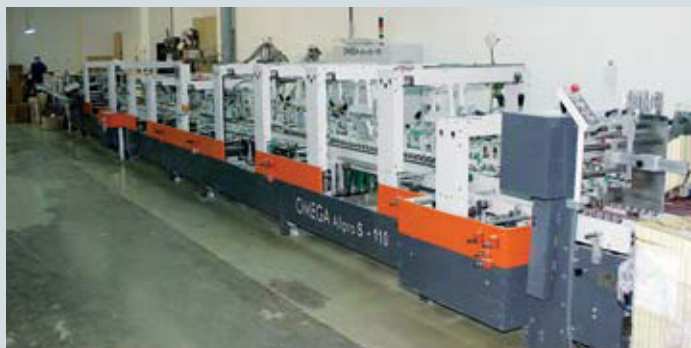
В последние годы МЦУ заметно усилил парк послепечатного оборудования. Например, были приобретены две фальцевально-склеивающие линии: одна компании BOBST, вторая — турецкого производителя DURAN, позволяющая выполнять многоточечную склейку коробок
