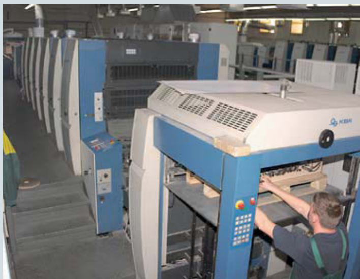
На МКПФ работает еще одна печатная машина от KBA — шестикрасочная Rapida 105U+L (слева). Офсетные печатные формы изготавливаются на CtP-устройстве Screen (справа)
