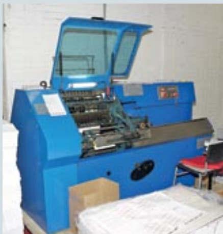
Ниткошвейная и крышкоделательная машины: часть пооперационного комплекса изготовления ежедневников. Справа — тигельный пресс, приспособленный для вырубки, в частности края покровного материала переплетных крышек
