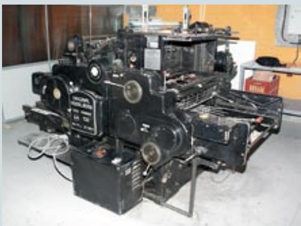
Стопцилиндровый пресс Original Heidelberg Cylinder используется для вырубки и тиснения фольгой
