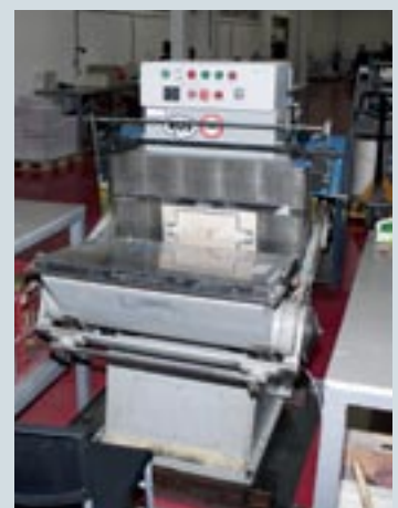
Ниткошвейная и крышкоделательная машины: часть пооперационного комплекса изготовления ежедневников. Справа — тигельный пресс, приспособленный для вырубки, в частности края покровного материала переплетных крышек
