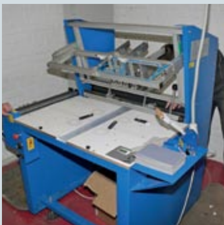
Ниткошвейная и крышкоделательная машины: часть пооперационного комплекса изготовления ежедневников. Справа — тигельный пресс, приспособленный для вырубки, в частности края покровного материала переплетных крышек
