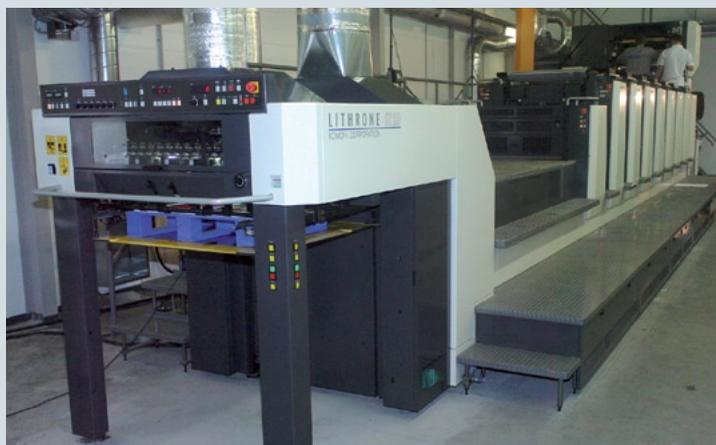
В типографии Violet Print инсталлировано новое оборудование: слева — термальное устройство вывода форм от компании Screen, справа — первая в России печатная машина с секцией холодного тиснения фольгой Komori Lithrone SX29
