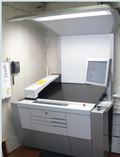
Пульты управления машинами Speedmaster (предыдущего и нового поколения) со встроенной системой Prinect Axis Control для колориметрического измерения оттисков
