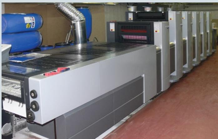
Парк печатного оборудования типографии «Синержи» представлен тремя машинами Heidelberg: двухкрасочным Speedmaster 52–2 и двумя пятикрасочными машинами с секциями лакирования Speedmaster 74 и Speedmaster 75
