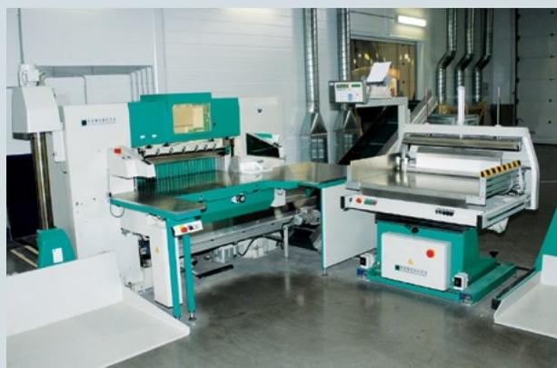
Уникальный резальный комплекс на базе машины Perfecta с комплектом вспомогательного оборудования
