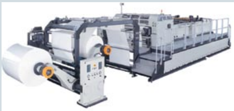
Профессиональное листорезальное устройство (флаторез). Использование такого устройства позволяет существенно экономить на бумаге как за счет оптимизации формата, так и использования более дешевой рулонной бумаги
